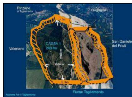
Le Casse di espansione Verrebergo realizzate a valle del ponte di Pinzano in un ambiente che si sta rinaturalizzando. Gli impatti sarebbero enormi non solo per il SIC
